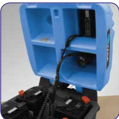
ной работы в автономном режиме. Электропитание осуществляется от 4 аккумуляторных батарей напряжением по 6 В. Для размещения аккумуляторов в машине предусмотрен отдельный четырехкамерный отсек, который защищает батареи от повреждений из-за ударов или тряски во время уборки.
