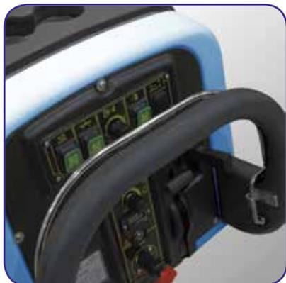
Интуитивно понятная панель управления позволяет регулировать скорость движения машины, отслеживать уровень заряда аккумуляторной батареи и изменение направления хода машины.
