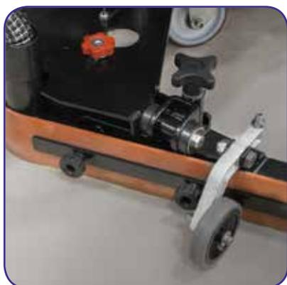
Ширина всасывающей балки 90 см. Во время стоянки машину надежно удерживает на месте стояночный тормоз.
